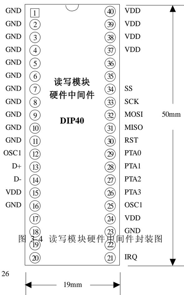
图 3-4 读写模块硬件中间件封装图
