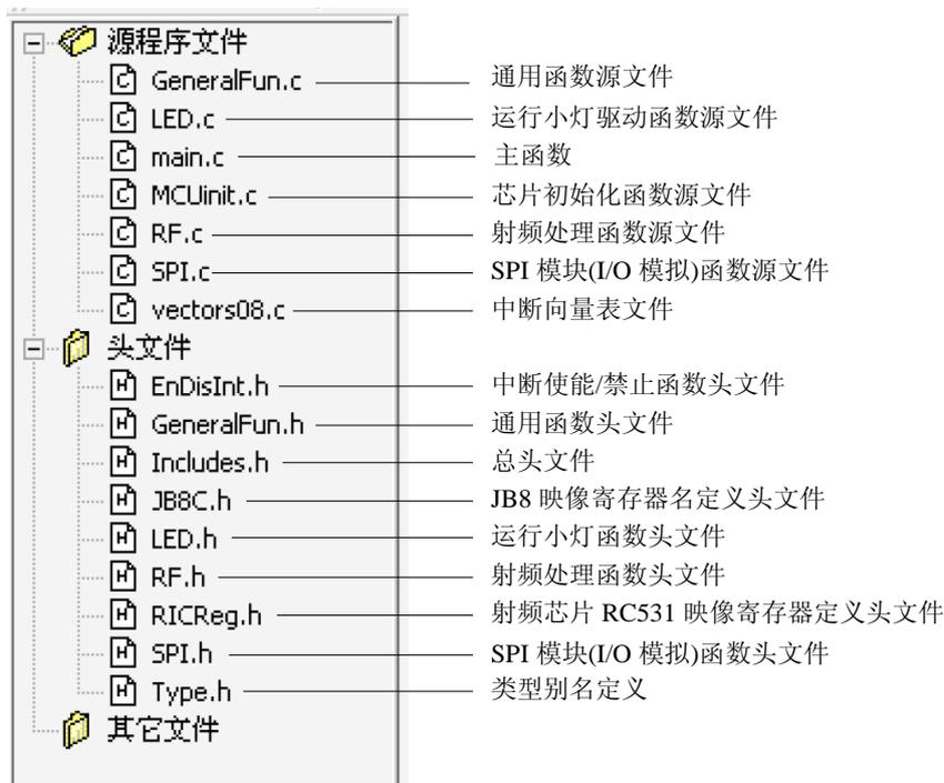
图 4-1 JB8 的 C 程序工程在 MT-IDE 下的文件视图
