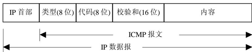
图 2-6 封装在 IP 数据报内的 ICMP 报文
