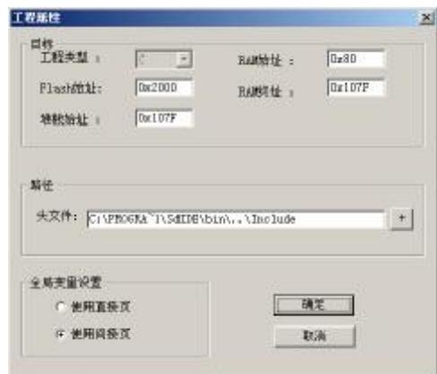
图 5-9 主控 MCU 与硬件相关参数设置界面
