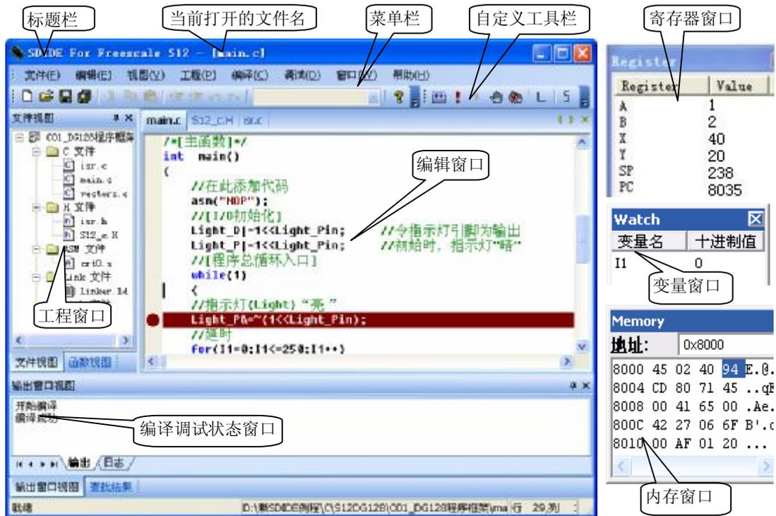
图 2-5 SdIDE12 中的断点的调试状态
